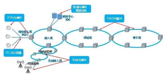
公司的光收发模块使用两种技术平台,即传统的分立式封装技术和硅光子集成技术。基于硅光子集成技术制造的硅 光收发模块主要应用于 56 前传和数据通信两大领域。
